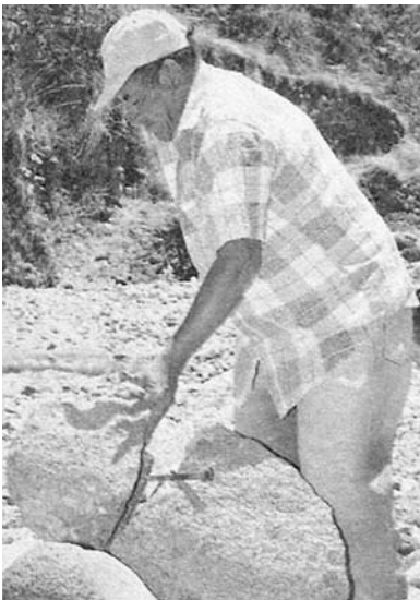
Ilustraciones Nos. 25, 26 y 27 Introducción de las cuñas de acero y el golpe simultáneo para desprendes la piedra, hasta que se rompe (Referencia: Carlos Sebastián 2007)
